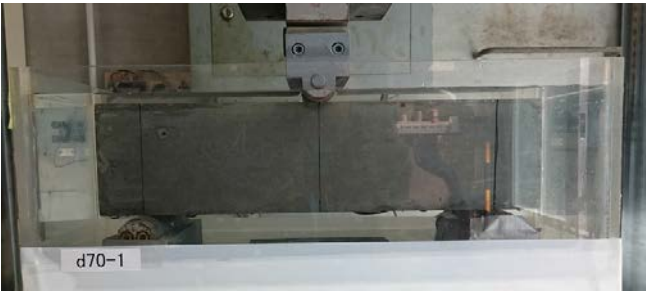
写真 1 水中疲労載荷状況
