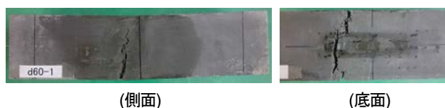
写真 3 試験終了後の試験体 (上限応力比 60%)
