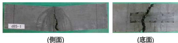
写真 2 試験終了後の試験体 (上限応力比 85%)
