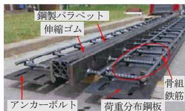
図-1 荷重分布型伸縮装置
