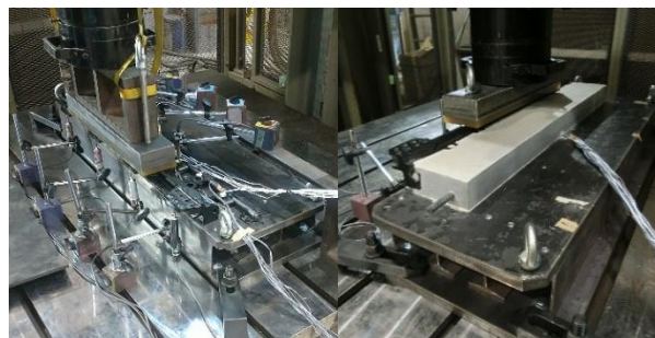
図-4 試験状態 (左:モルタル無し 右:モルタル有り)
