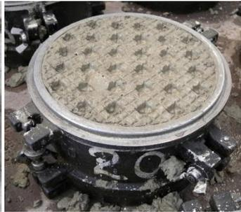
写真3 凹凸処理
