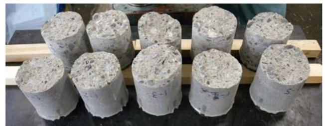
写真 1 木ゴテ処理の場合の試験後の状況
