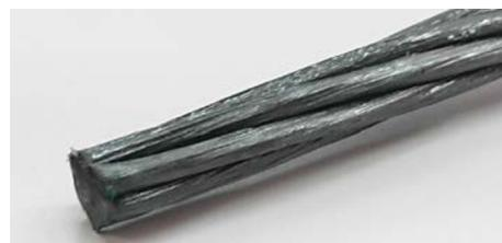
図-1 TP-CFRPの外観
