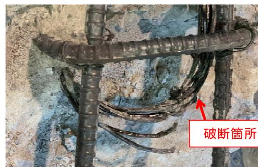
図-4 半円形フック始点付近での破断状況
