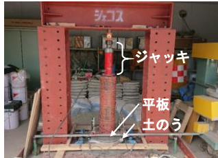
図4 繰返し平板載荷試験の概要
