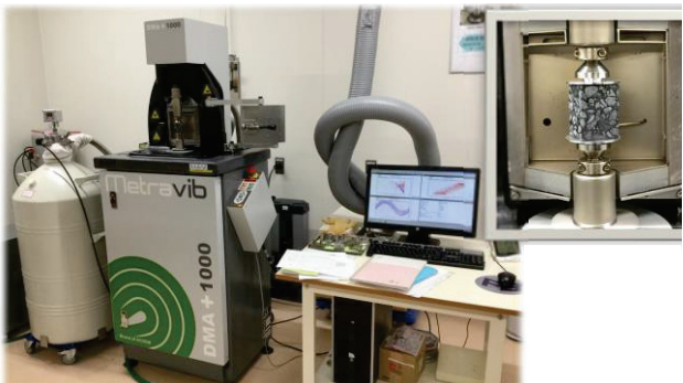
写真-1 DMA 装置による動的粘弾性測定状況
