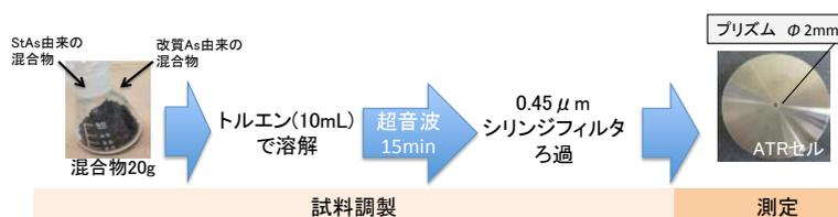
図-1 アスファルト混合物からの抽出および測定手順
