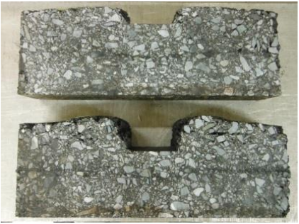
写真－1 WT 試験後供試体 (上: 非挿入, 下: 3mm As シート)
