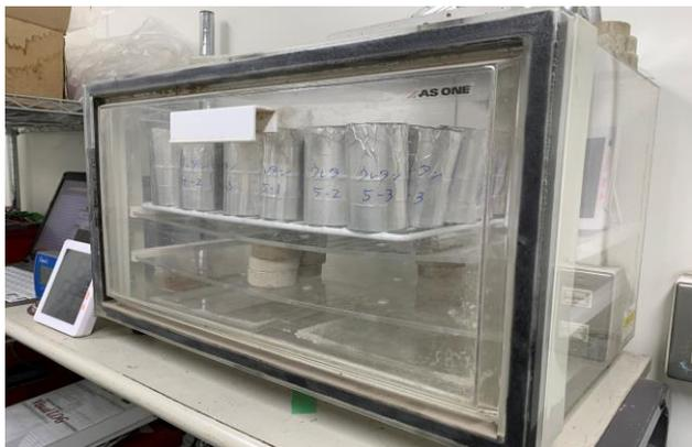
写真 1 水蒸気浸透実験
