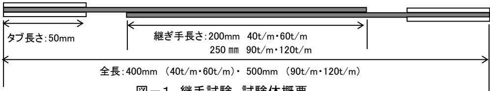
図-1 継手試験 試験体概要
