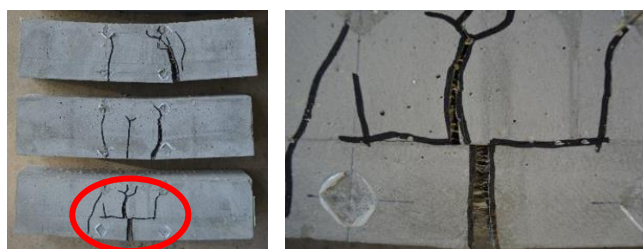
図4 加力後写真 (P3A7)
