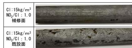
写真-1 腐食鉄筋の様子
