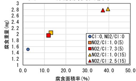
図-6 腐食重量と腐食面積の関係
