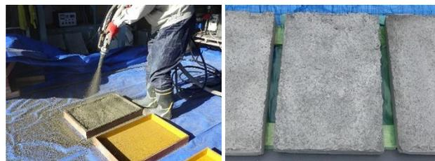
写真-1 供試体作製状況 写真-2 作製した供試体
