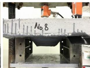
写真-6 押抜き試験状況
