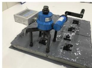
写真-5 付着強さ試験状況
