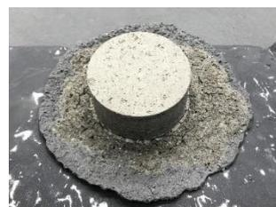
写真-7 剥離面での母材破壊
