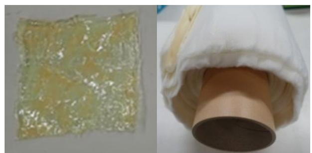
写真-1 熱可塑性樹脂 (プレート型と不織布型)
