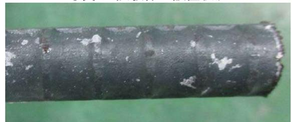
写真2 解体後の鉄筋の状況
