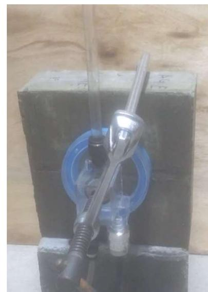
写真 1 表面吸水試験の様子
