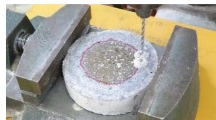
図-4 境界上を削孔している様子
