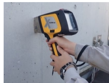
写真-1 ハンディ型蛍光 X 線分析装置（表面法）
