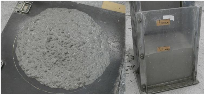
図-3 分離抵抗性に劣るコンクリートのサンプル試験結果：平均スランプフロー値 605 mm ; 粗骨材がフロー中心部に多く残り（左），ボックス試験上昇高さ（ランク 2：鉄筋 3 本）170mm に留まった（右）
