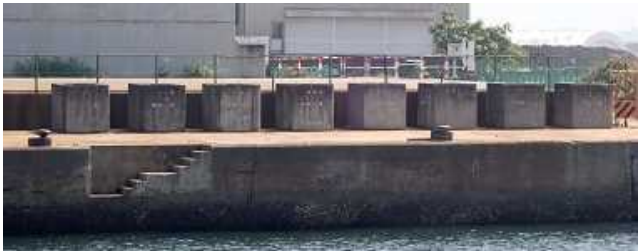
写真-1 供試体の暴露状況
