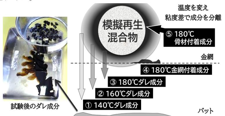
図1 試験概要および模擬再生混合物とダレ成分の様子
