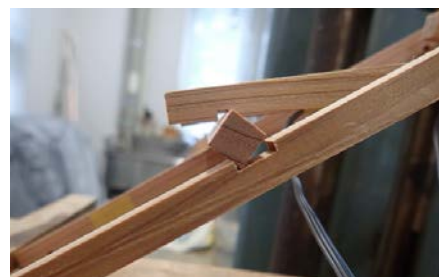
図 4 横材の転倒 (Case2 破壊時)
