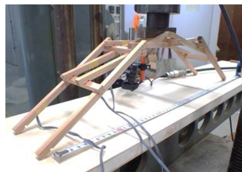
図2 小試験体(Case1)
