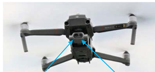
映像用カメラ 熱画像用カメラ 図-3 2種類のカメラ搭載ドローン
