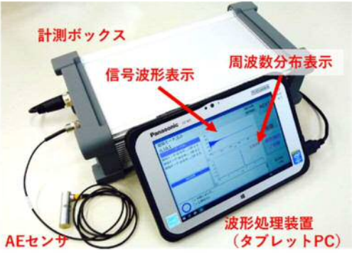
図-1 AE 打音点検装置の外観
