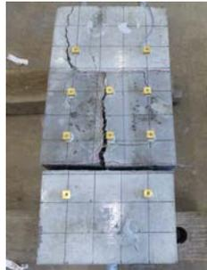
図-2-b TypeB 損傷状況
