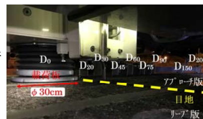
写真.5 載荷板およびたわみセンサー
