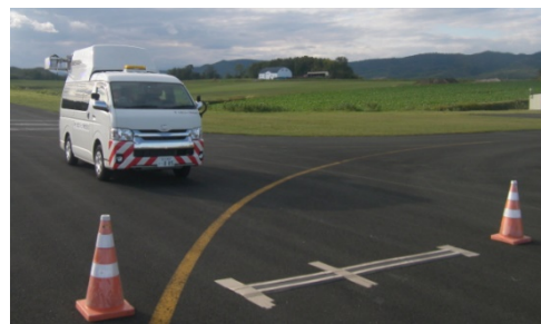
写真-1 模擬段差設置状況
