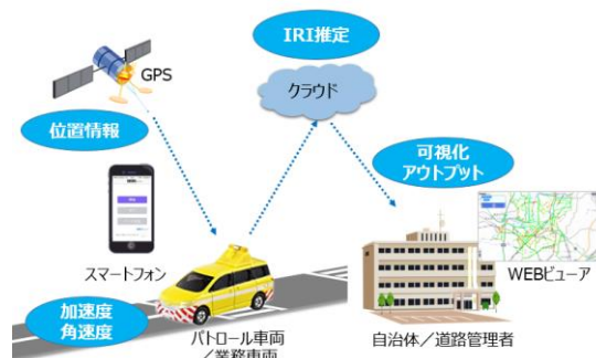
図-1 スマートフォンを用いた点検システム
