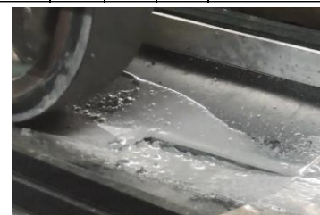
写真-1 ポンピング試験状況 (No. 1)
