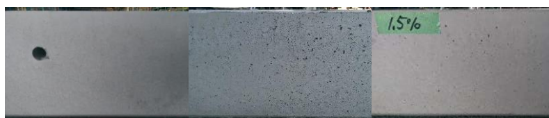
図-4 型枠面の表面性状(左:Non AE, 中:AE con, 右:MS1.5%)
