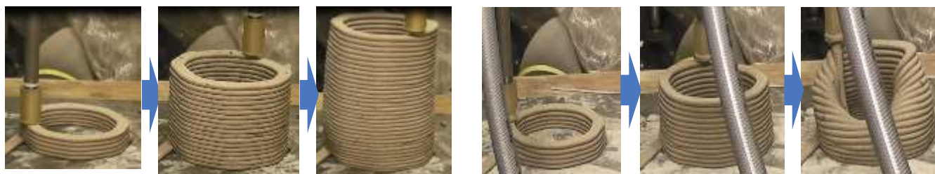
図-2 配合 A（左）及び B（右）を用いた積層体作製の様子
