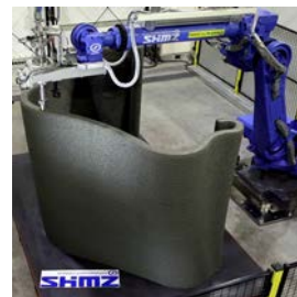
図-4 埋設型枠の製作状況
