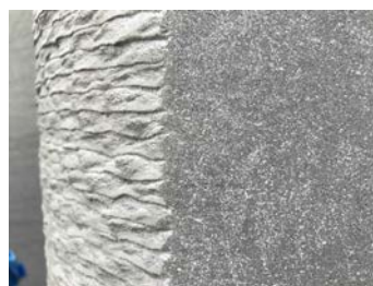
図-1 積層体の切断面
