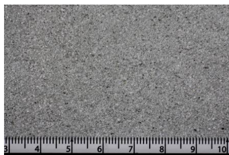
写真－3 プリント試験体の表層を切断した面
