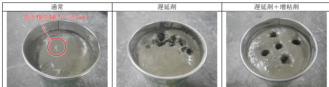
図-1 24時間後のコンクリート表面の状況
