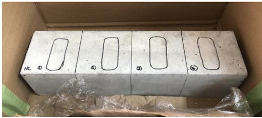
写真-2 試験体の測定位置（枠線内）
