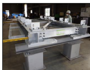
写真-3 Al・Mg めっき採用例 鋼鉄道橋
