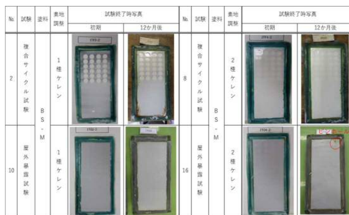
図-4 外観状況（試験片No.2, 8, 10, 16 抜粋）
