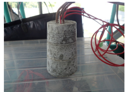
写真-2 モルタルと一体化した比抵抗計
