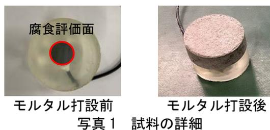
モルタル打設前 写真1 試料の詳細
