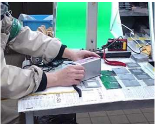
図-3 光沢度計測状況 (所定の光源 60° で評価)
