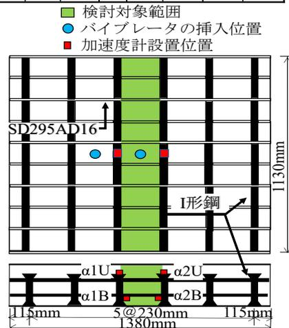
図-1 供試体の概要
