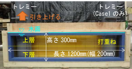
図-1 実験概要(下層コン打設前)
