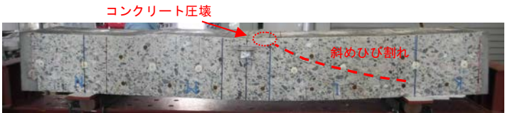
図 2 載荷後の試験体 (No. 3)
