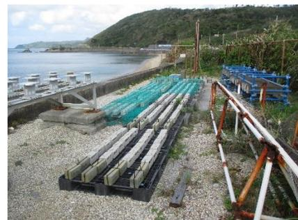
写真1 曝露試験状況 (沖縄県)
