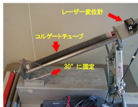
図-1 長さ変化試験装置
