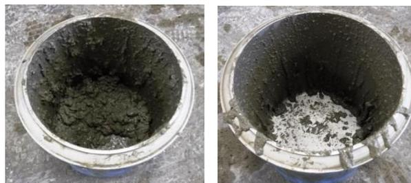
図-3. コンクリート排出試験結果
