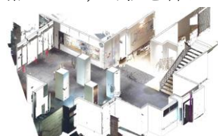
図 3 点群データを参照にして BIM モデルを作る模様
