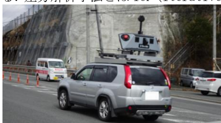
図-1 法面の点群を取得しているMMSの様子
