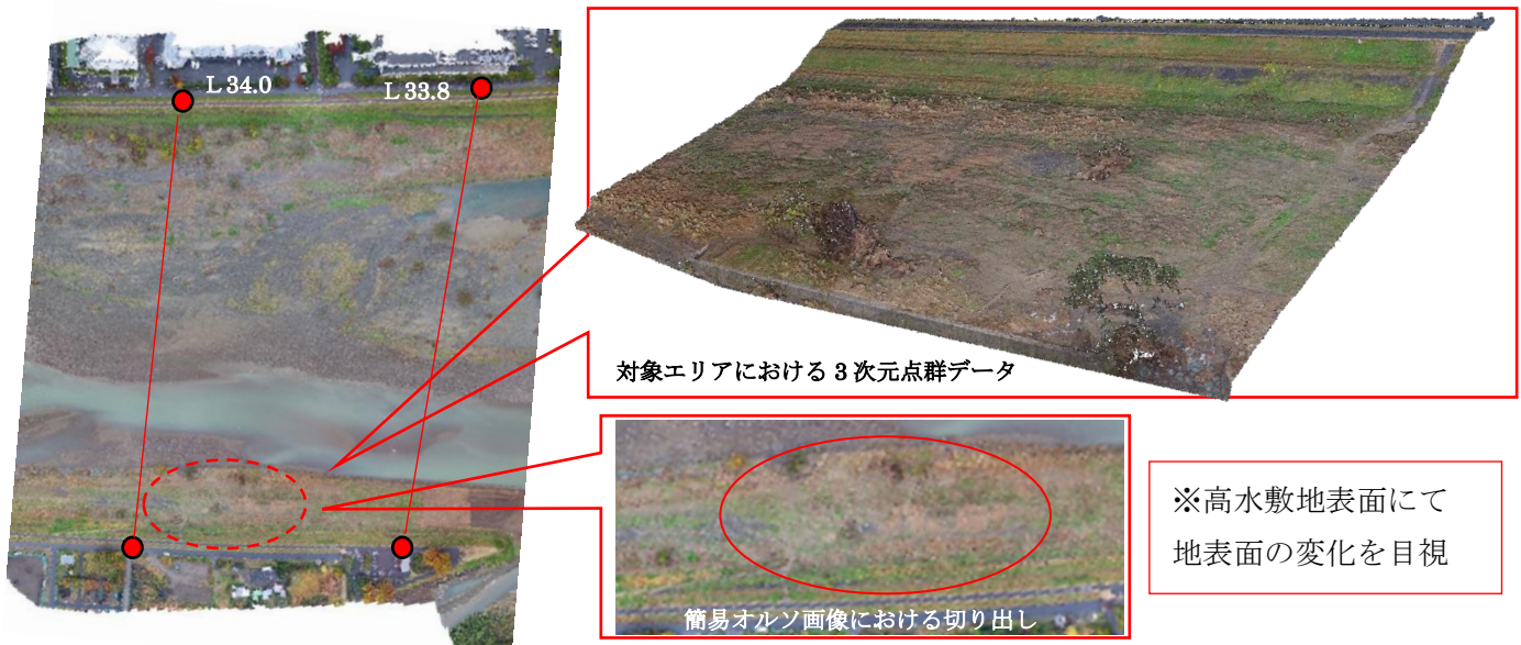
画像-2 令和元年11月撮影データより作成した簡易オルソ画像と3次元点群データ
