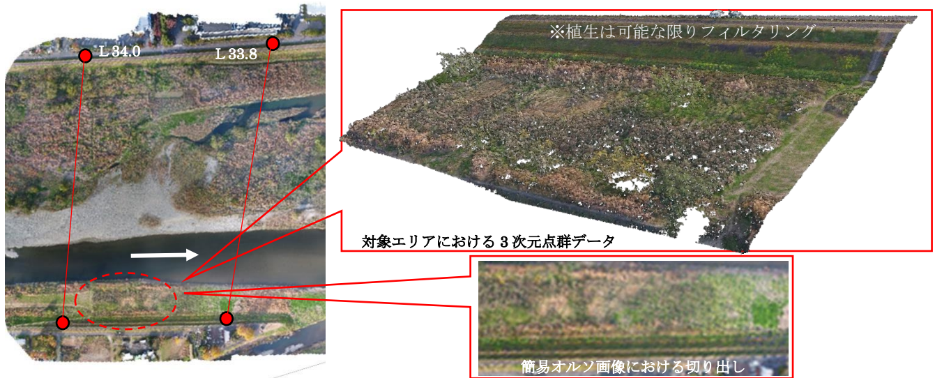
画像-1 平成30年11月撮影データより作成した簡易オルソ画像と3次元点群データ
